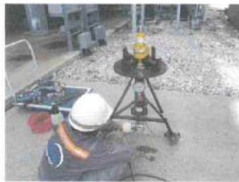
รูปที่ 3 การทดสอบการระบาย / POP TEST
