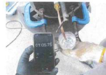
รูปที่ 6 การทดสอบการรั่วซึม / SEAT LEAKAGE TEST
